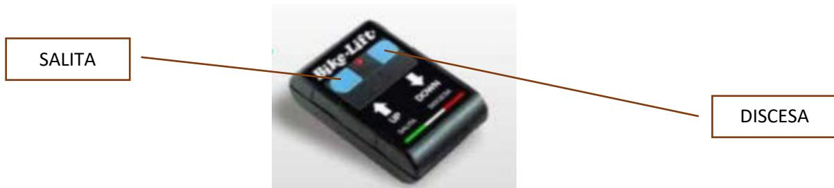
Figura 10 – pulsantiera a comando remoto con comando ad azione mantenuta
