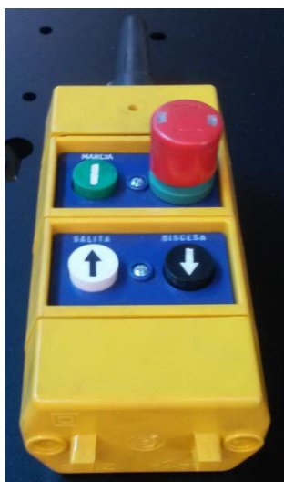
Figura 11 – pulsantiera per il sistema floor
