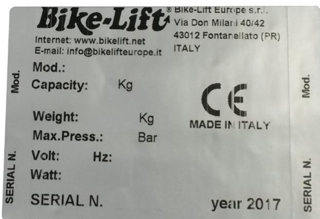
**Bild 1 – Beispiel vom Identifizierungsschild, welches auf dem Gerät angebracht wurde**
