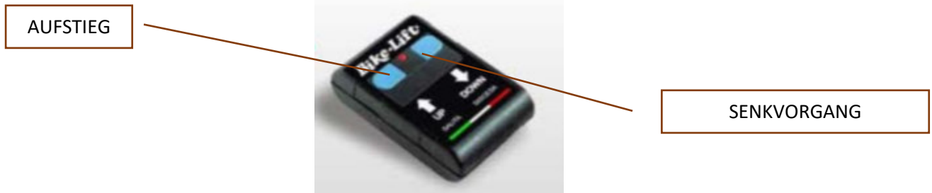
Abbildung 8 – elektronische Druckknopftafel mit Fernsteuerung und Totmanntastenschaltung
